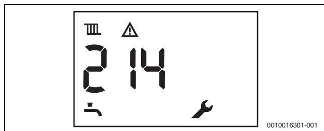
Fig. 6 Exemplu de cod de defecțiune
